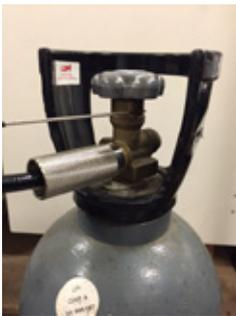
Raccorder le flexible haute pression à la bouteille de CO2 en serrant la molette à la main.
