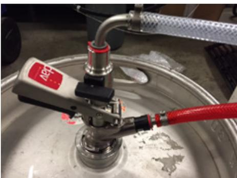
Mettre en perce le fût : percuter la tête. Ouvrir le robinet d'arrêt de la tête de débit. Replacer le couvercle correctement.
