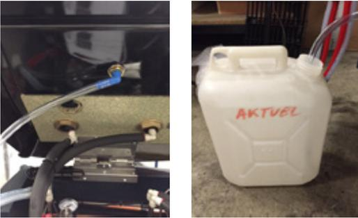
Raccorder le tuyau de vidange de l'égouttoir dans le bidon vide fourni par AKTUEL
